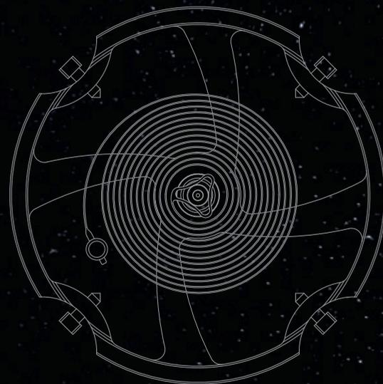
*Балансовые колеса турбийона и карусели имеют ИНЕРЦИОННУЮ РЕГУЛИРОВКУ, А СПИРАЛИ ВЫПОЛНЕННЫ ИЗ КРЕМНИЯ.*
