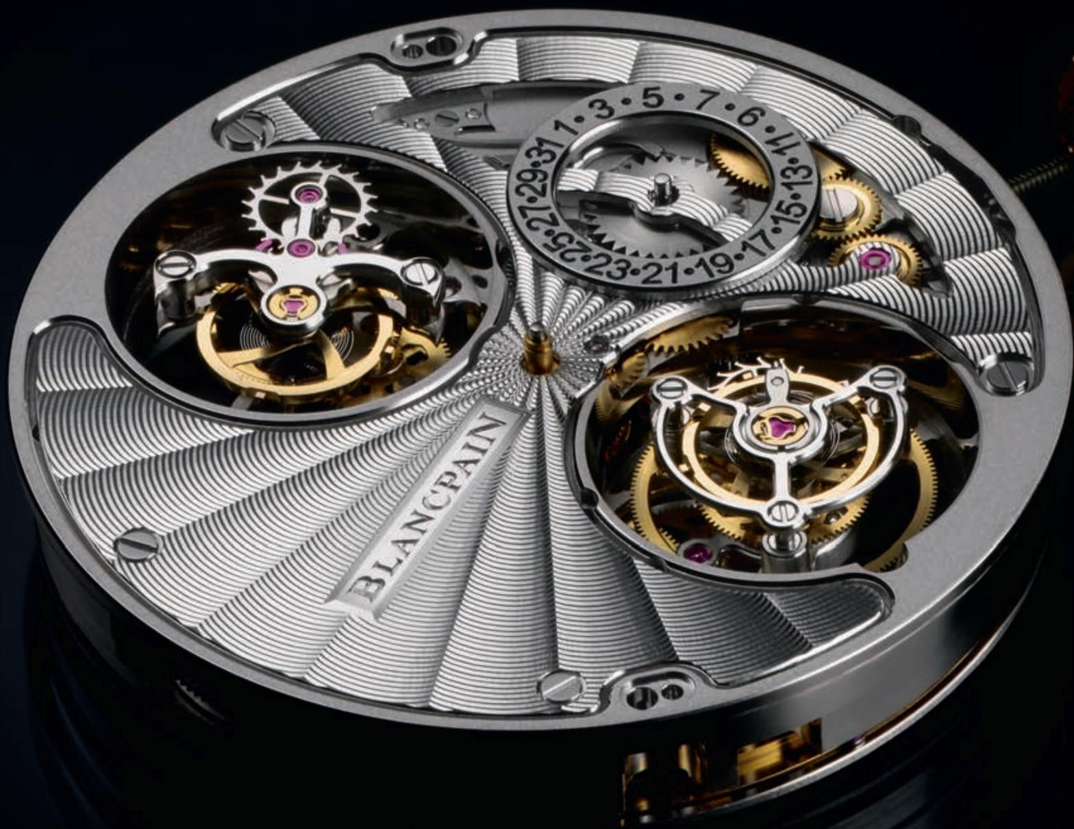
Решение приобрело форму большого заводного кольца, охватывающего механизм по периферии. Оснащенное зубьями, это большое наружное кольцо может приводить в движение заводные колеса обоих барабанов одновременно. Несмотря на «кольцеобразный» дизайн, разработчики механизма Blancpain предпочитают называть его «заводная головка», потому что его цель состоит в том, чтобы взводить оба барабана.
