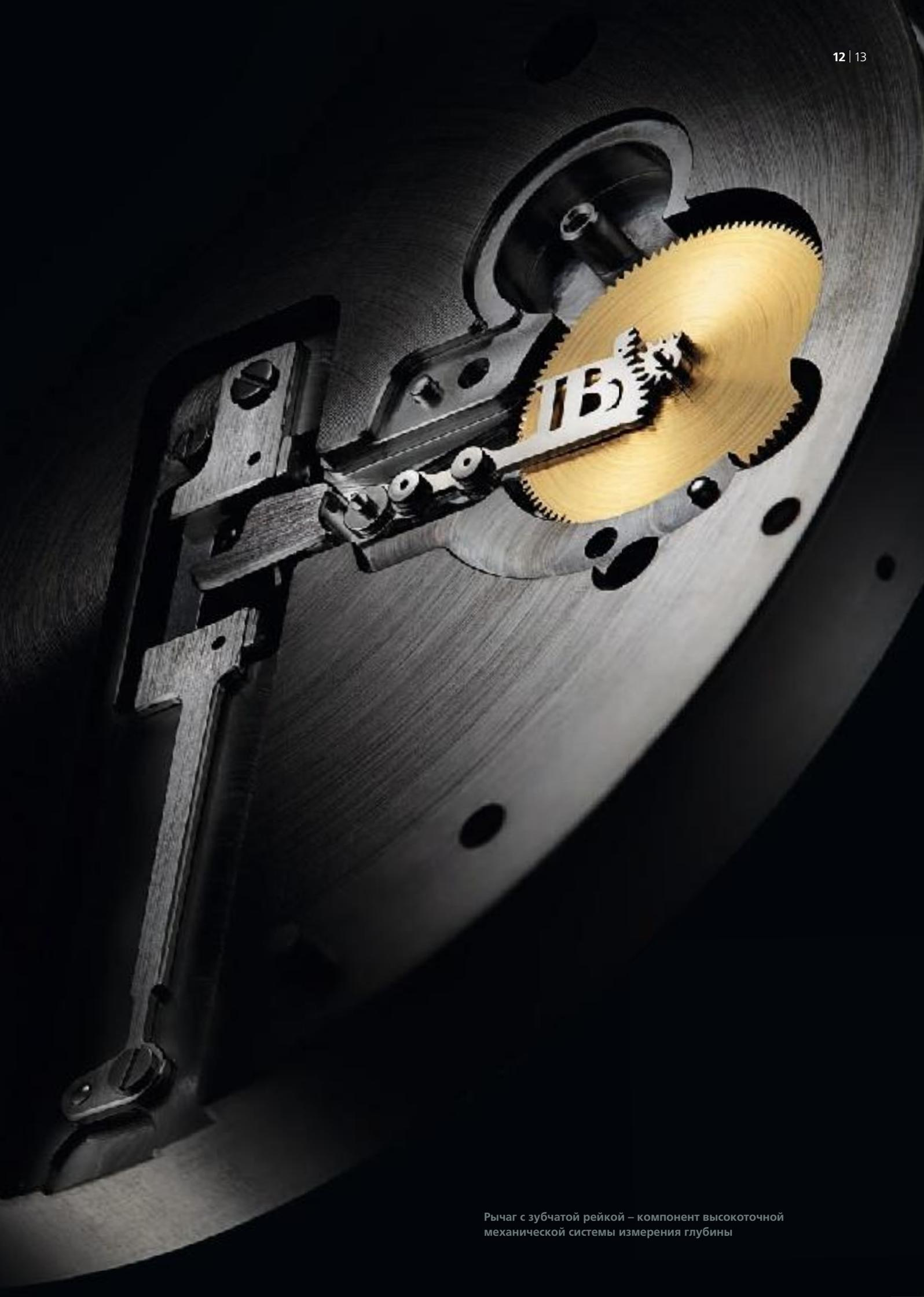
Рычаг с зубчатой рейкой – компонент высокоточной механической системы измерения глубины
