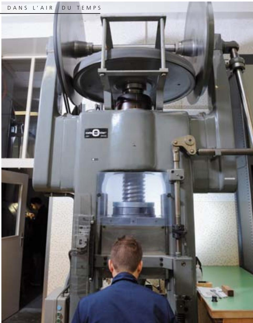
À gauche, la presse à étamper découpe les ouvertures des cadrans. À droite, la Villeret Chronographe Monopoussoir, le cadran havane et le creusage des compteurs du chronographe.
