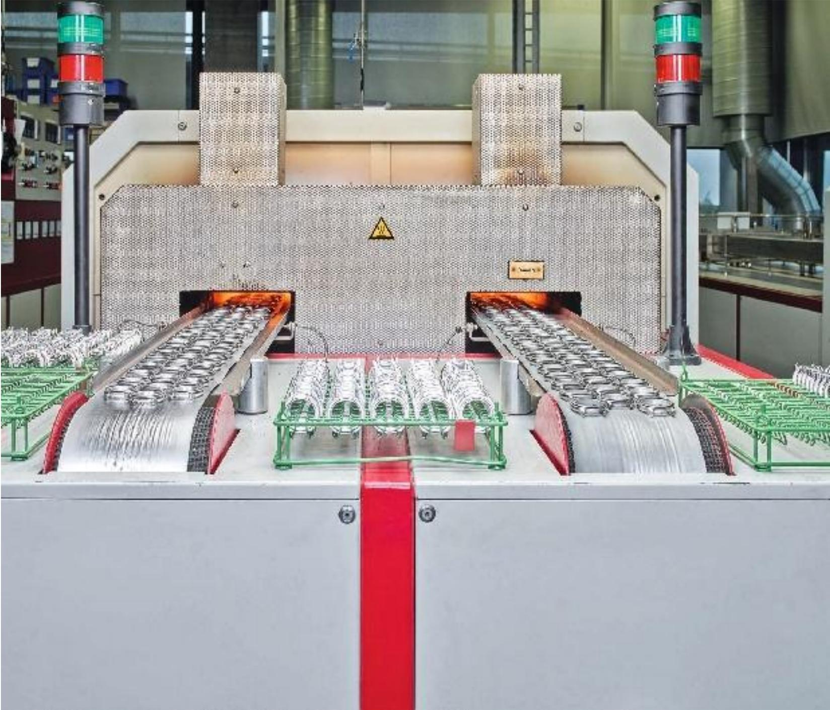
Arriba y al lado: Entre las operaciones de estampado sucesivas, las cajas se someten a un proceso de calentamiento/enfriamiento.
