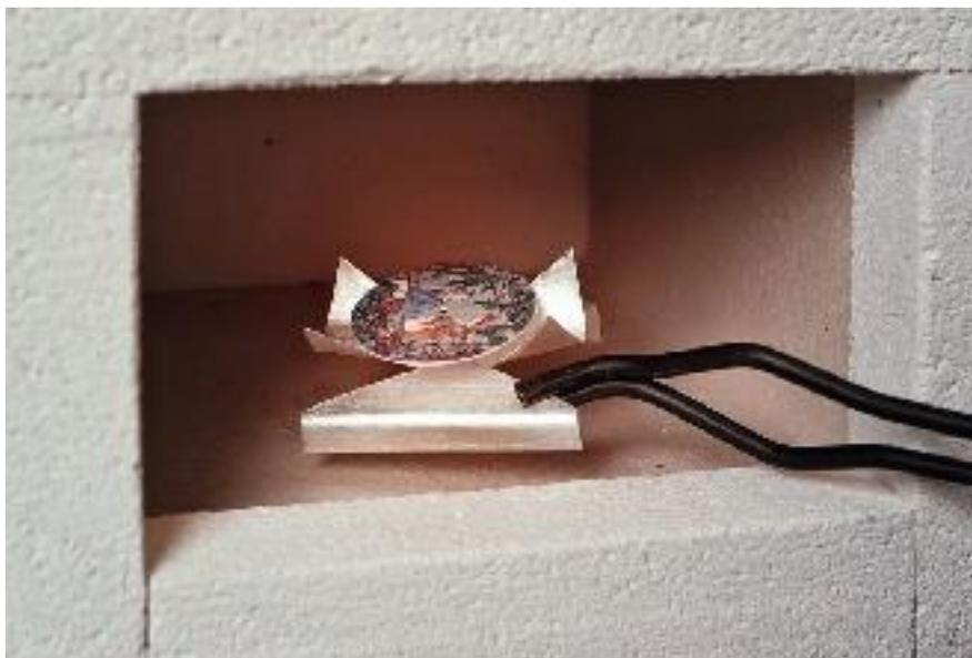
Izquierda: Horno utilizado para la cocción del esmalte.
