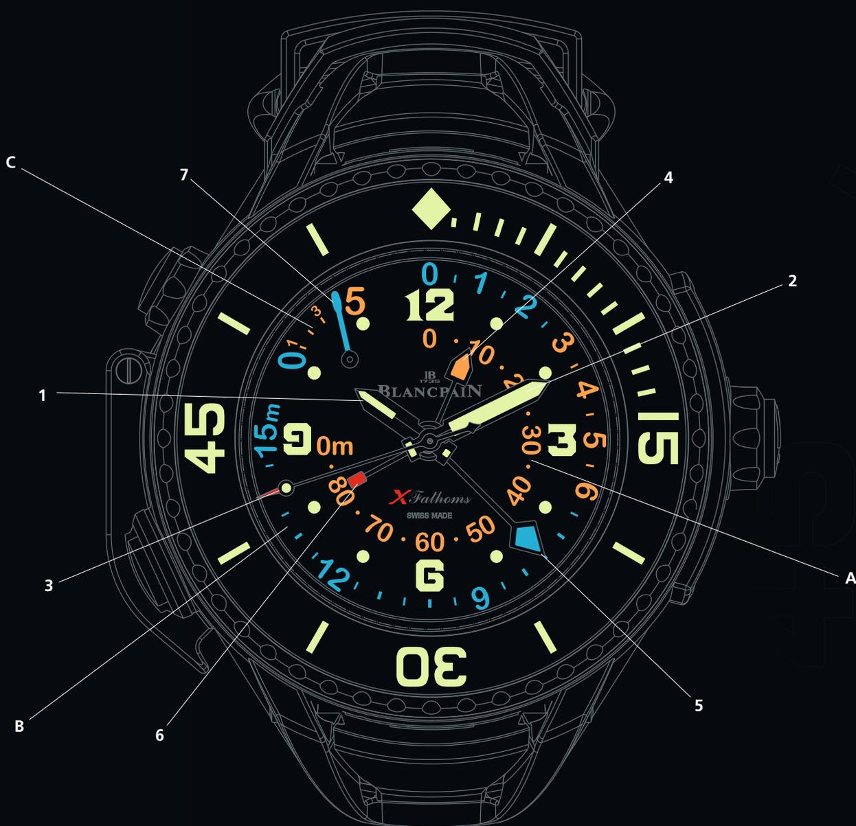
1 Aguja de las horas 2 Aguja de los minutos 3 Aguja de los segundos 4 Aguja de la profundidad real (escala 0-90 metros) 5 Aguja de la profundidad real (escala 0-15 metros) 6 Aguja de la profundidad máxima registrada 7 Aguja de la cuenta atrás de 5 minutos A Escala de profundidad 0-90 metros B Escala de profundidad 0-15 metros C Contador de cuenta atrás de 5 minutos para las paradas de descompresión
