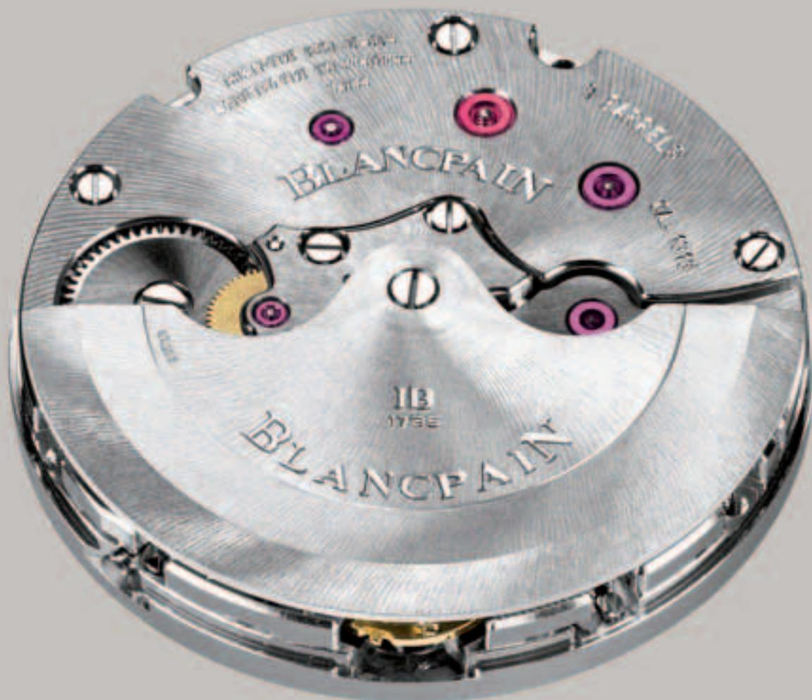
El calibre 1315 luce rubíes extragrandes, presenta acabados soleados, un volante de inercia variable con regulador de cuello de cisne y tornillos de regulación cuadrados sobre el aro del volante.
