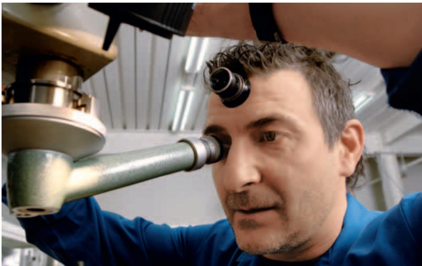
Control visual de una masa oscilante sobre la máquina de medir por centrado.
