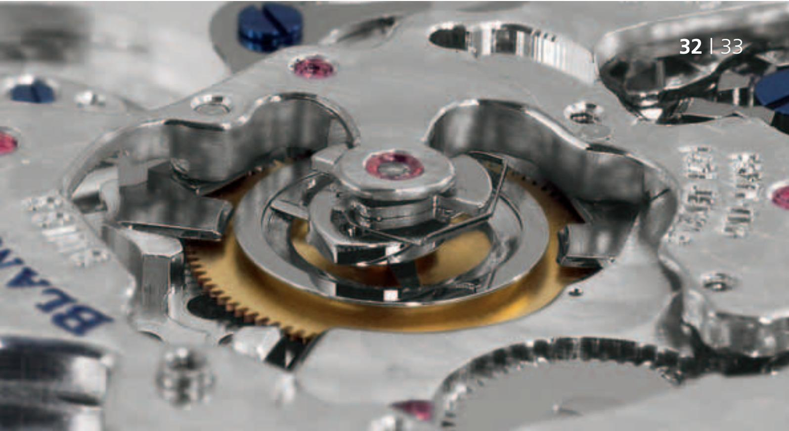
Vista del embrague vertical con los dos brazos sobre cada lado (en posición de cronógrafo parado). Para esta foto se ha recortado el puente superior que habitualmente protege al sistema de embrague.
