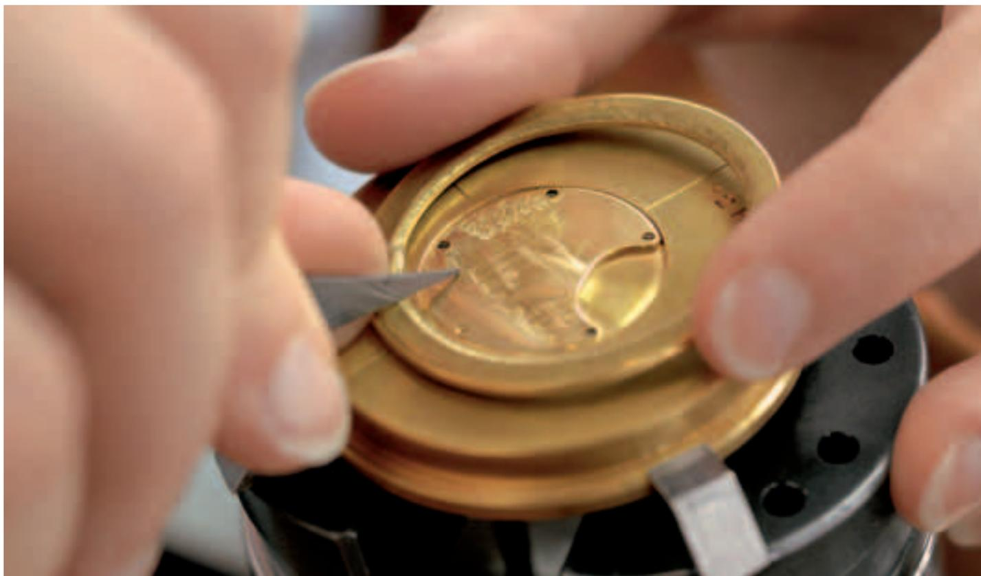
Grabado del fondo de un repetición de minutos hermético por incisión en la materia, mediante un pequeño buril. Un trabajo de orfebre realizado a mano bajo el microscopio.
