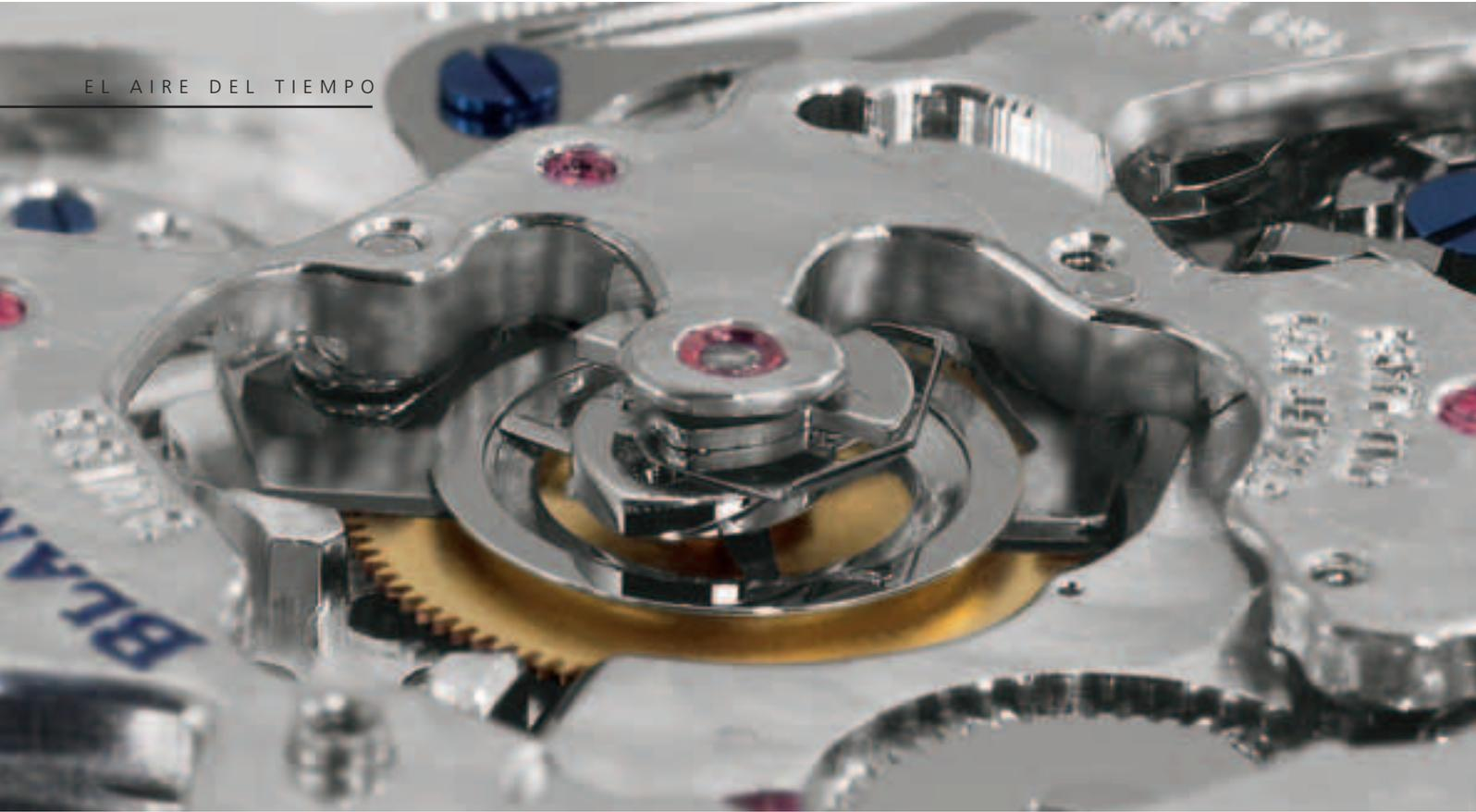
Imagen con el cronógrafo en marcha. Los dos brazos están separados de la platina de embrague para permitir que el disco quede presionado sobre la rueda de segundos que está en continuo movimiento. A las 5 y a las 10 horas se distinguen dos de los tres muelles de embrague. Sobre el conjunto del embrague se puede observar el dedo del muelle que regula el contador de minutos.
