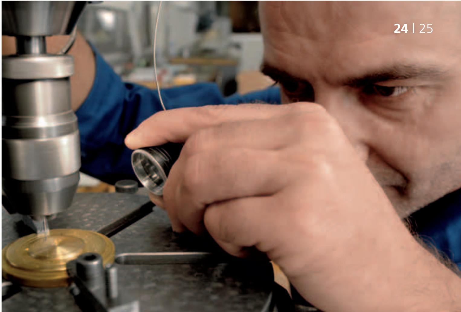
Fresado interior y exterior de la masa oscilante de oro del tourbillon calibre 25 sobre la máquina de medir por centrado.
