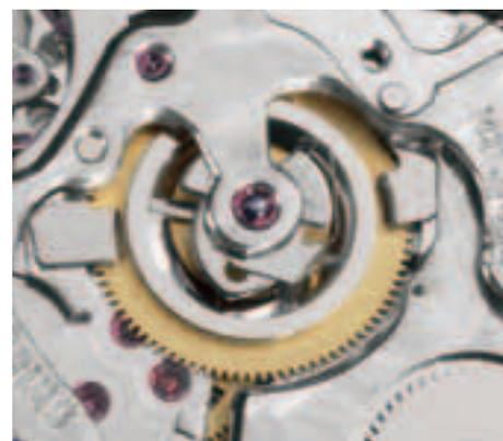
Vista superior del embrague con el cronógrafo parado. Los brazos levantan la platina de embrague.
