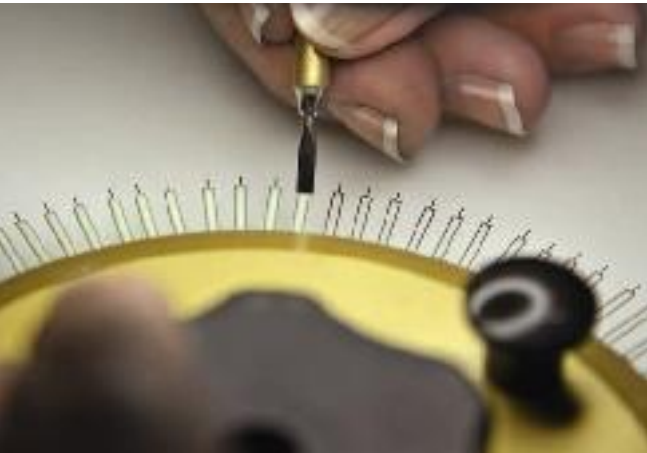
在Bathyscaphe腕表的指针背面手工涂上Super-LumiNova夜光涂料。
