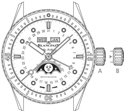
Lösen Sie die verschraubte Krone (**Position A**) vor jeder Manipulation und verschrauben Sie sie danach wieder.
