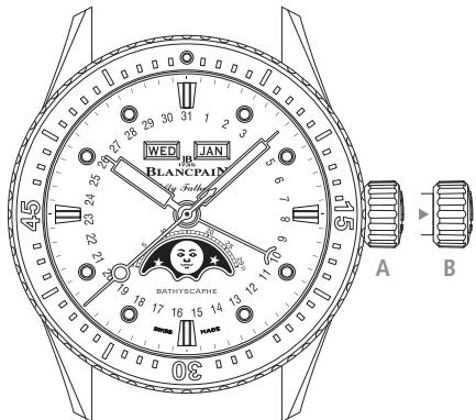
Para corregir las funciones de su reloj desenrosque completamente la corona (**posición A**). Tras terminar los ajustes necesarios, enrósquela nuevamente, llevándola a la posición inicial.
