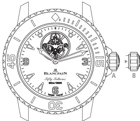
操作前にリュウズ（位置A）のネジ込みをゆっくりと緩め、セット後にリュウズを押し込みながら固定されるまで締め込んでください。
