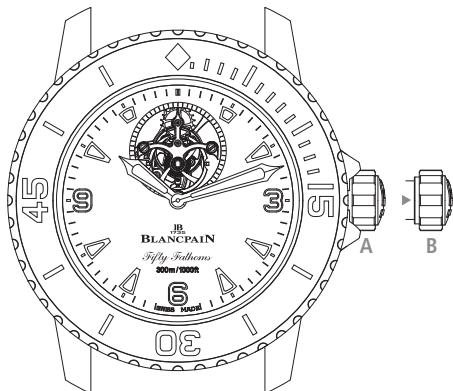
Para corregir las funciones de su reloj desenrosque completamente la corona (**posición A**). Al terminar los ajustes necesarios, enrósquela nuevamente, llevándola a la posición inicial.
