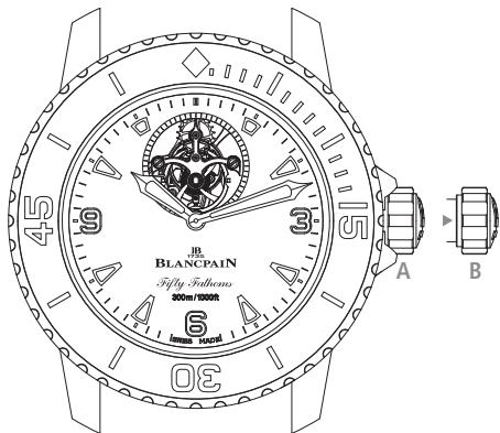
Lösen Sie die verschraubte Krone (**Position A**) vor jeder Manipulation und verschrauben Sie sie danach wieder.
