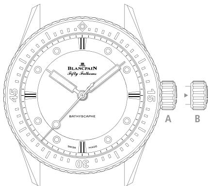
Para corregir las funciones de su reloj desenrosque completamente la corona (**posición A**). Tras terminar los ajustes necesarios, enrósquela nuevamente, llevándola a la posición inicial.
