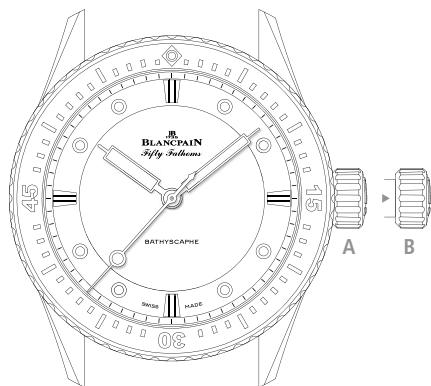
操作前にリュウズ（位置A）のネジ込みをゆっくりと緩め、セット後にリュウズを押し込みながら固定されるまで締め込んでください。
