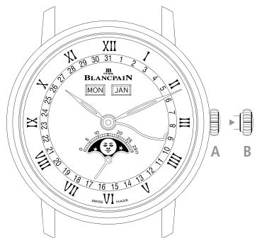
**Заводная головка имеет два положения**
